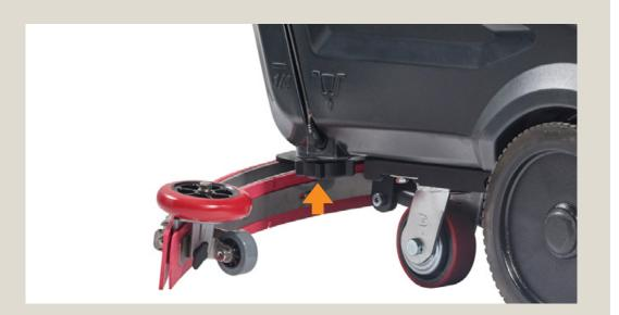
**Diariamente:** Vacíe el depósito de agua limpia con el grifo de vaciado del depósito de solución situado debajo de la máquina.
