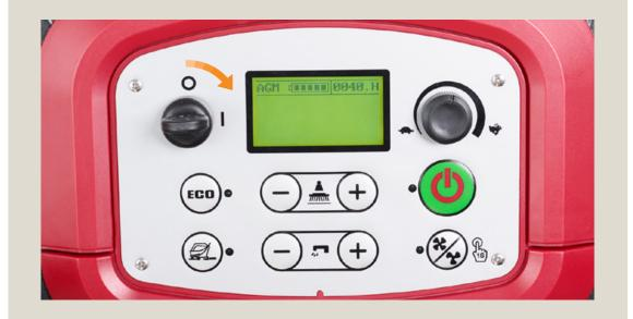
Encienda la llave y compruebe que la batería tenga suficiente carga para completar el trabajo. Cargue las baterías si es necesario.
