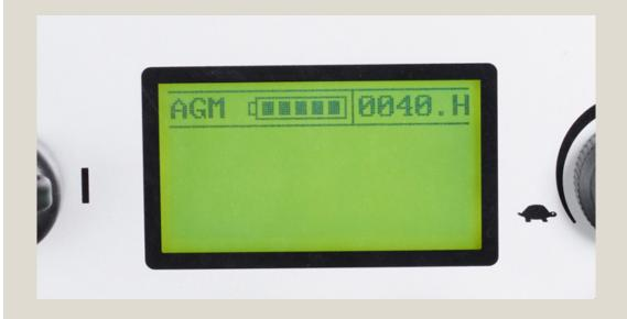
**Diariamente:** si el indicador de batería indica un nivel bajo, ponga la máquina a cargar. La batería debe cargarse si está vacía, si no se usa o si no se utilizará durante las próximas 8-10 horas.
