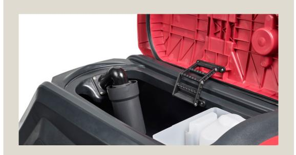
**Diariamente:** Inspeccione y enjuague el flotador. Inspeccione, revise y limpie la bandeja de residuos y limpie la junta de la tapa si es necesario.
