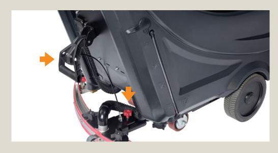
Use la palanca para subir/bajar la boquilla. Ajuste el ángulo de la boquilla con el regulador para ajustar el secado si es necesario.
