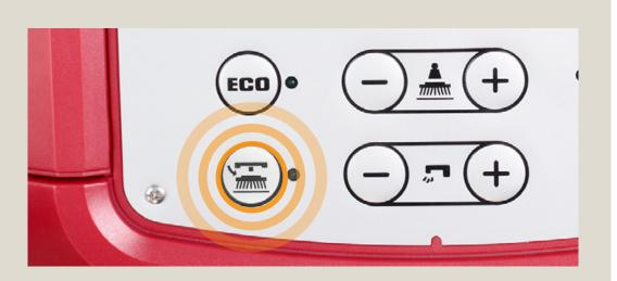
En la versión de disco, el soporte del cepillo/pad se puede extraer automáticamente levantando la plataforma y luego pulsando el botón de extracción.
