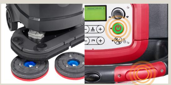
**Versión en disco:** coloque el soporte del cepillo/pad bajo la plataforma de fregado y a continuación, pulse el botón de fregado OneTouch™ para fregar; la cubierta bajará automáticamente. Se iniciará la aspiración. Pulse uno de los dos pulsadores del mango ½ segundo para colocar el cepillo.
