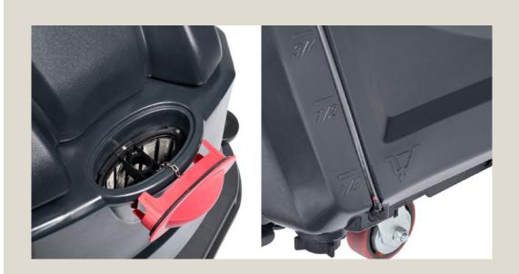
Retire la tapa roja y llene el depósito con agua, a una temperatura máxima de 40 °C. Añada el detergente adecuado con poca espuma. La capacidad máxima del depósito es de 85 L. Compruebe el nivel con la bola roja en el lateral de la máquina.
