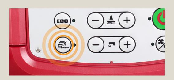
Botón Preparación del suelo (orbital) para decapar: la presión del pad se fijará al máximo, el caudal de solución se ajustará al mínimo y la velocidad de la máquina se mantendrá a 1 km/h.
