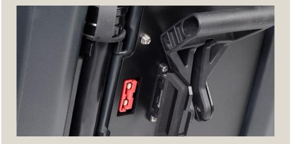
**Diariamente:** para cargar la batería, conecte el conector del cargador a la conexión de carga exterior de la máquina, y enchufe el cargador a la toma de corriente. Compruebe que la carga haya comenzado con la luz del indicador del cargador. Si la máquina incluye el cargador integrado, incline el depósito de recuperación y conecte el cargador integrado de la misma manera.
