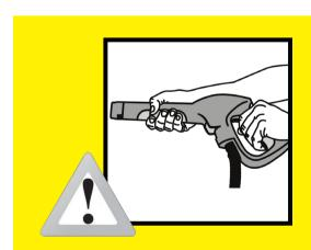
Al finalizar el uso, apague el motor, cierre el grifo y presione el gatillo para eliminar la presión en la bomba. RECUERDE, CON EL MOTOR APAGADO!
