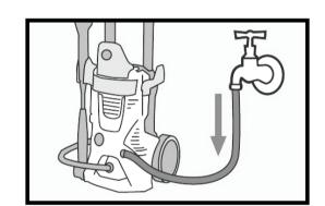
Conecte la máquina a la red de agua y abra el grifo, pero no encienda la máquina.
